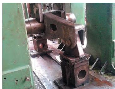
Рис. 2. Общий вид усталостных испытаний корпуса буксы
