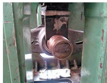
Рис. 2. Общий вид усталостных испытаний корпуса буксы
