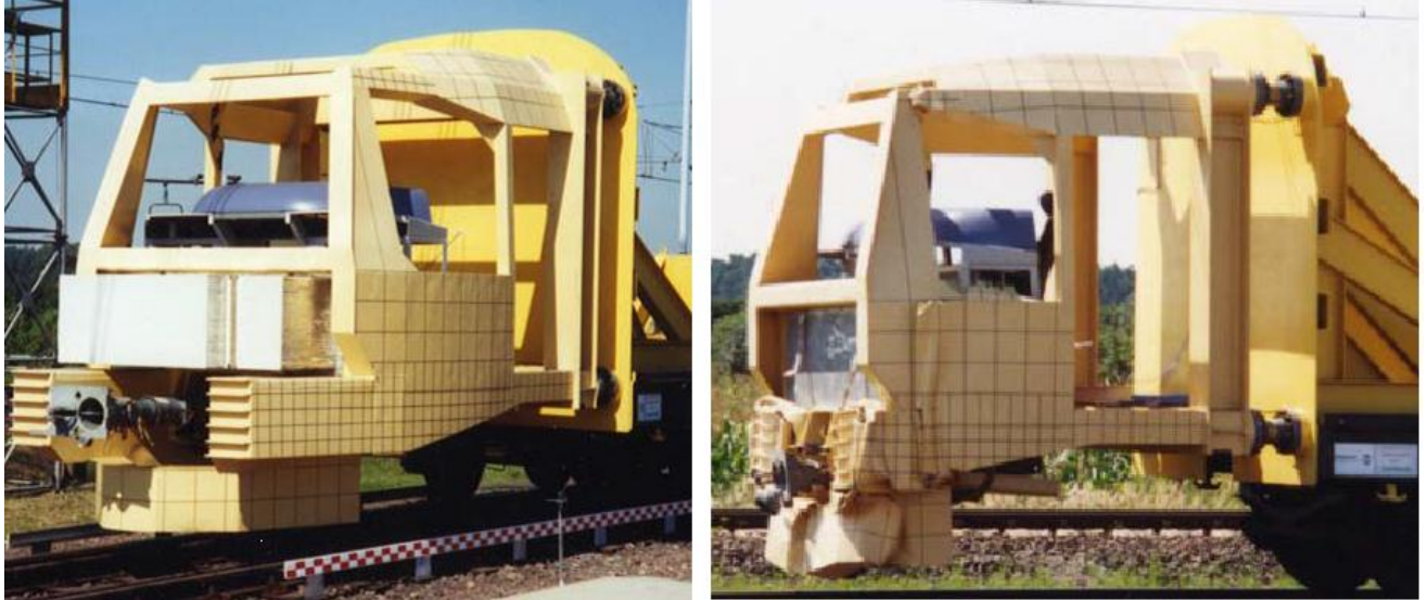
Рисунок 3.2 – Испытания с установкой устройств поглощения энергии на макеты единиц подвижного состава
