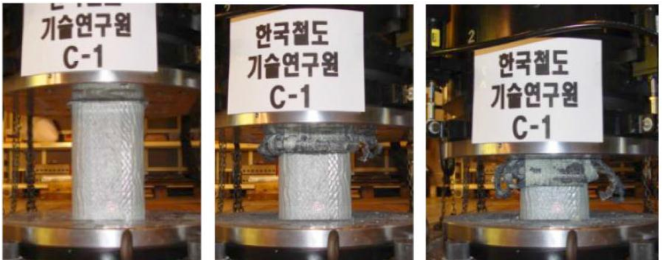
Рисунок 1.8 – Устройство поглощения энергии из полимерного композита
