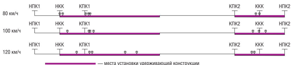
Рис. 6. Места возникновения максимальной поперечной силы при движении подвижного состава
