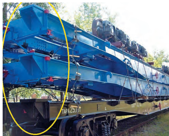
Рис. 2. Вынос крайних опор за раму платформы мод. 23-469-07
