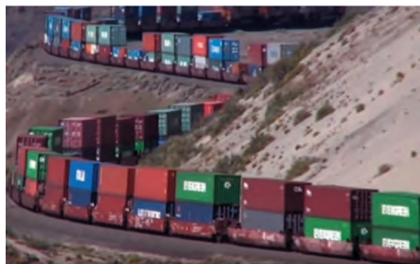
Рис. 3. Фрагмент контейнерного поезда с двухъярусной погрузкой контейнеров
